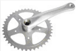
170 X 42T PEDIVELLA ALLUMINIO PERNO 122.5mm
